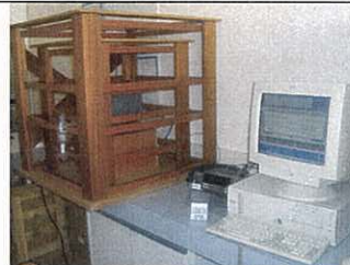
Système d'exposition. Le système d'exposition est composé de bobines de Merritt monitorées par un contrôleur de voltage. La température et le champ magnétique sont contrôlés en temps réel pendant l'exposition.
